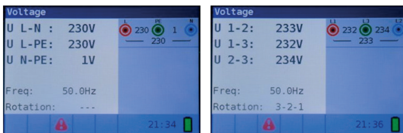
Figura 4 34: Ejemplos de mediciones de tensión y frecuencia
