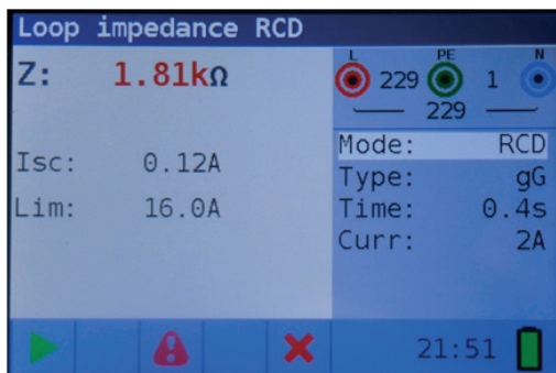
Figura 4 25: Ejemplo de resultado de la medición de la impedancia del bucle de fallo usando la función de bloqueo del disparo
