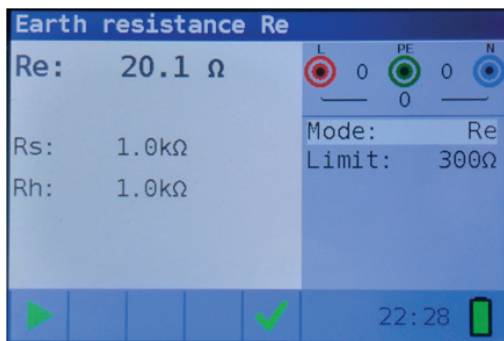
Figura 4 38: Ejemplo de resultado de la medición de resistencia de tierra
