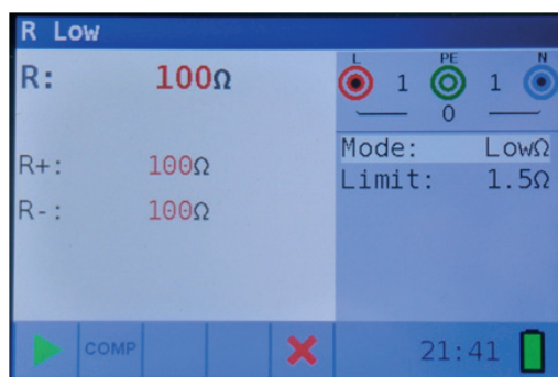
Figura 4 7: Ejemplo de resultados de medición R Baja
