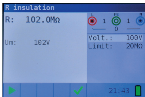
Figura 4 3: Ejemplo de los resultados de una medición de resistencia de aislamiento
