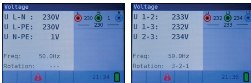
Figura 4 34: Ejemplos de mediciones de tensión y frecuencia
