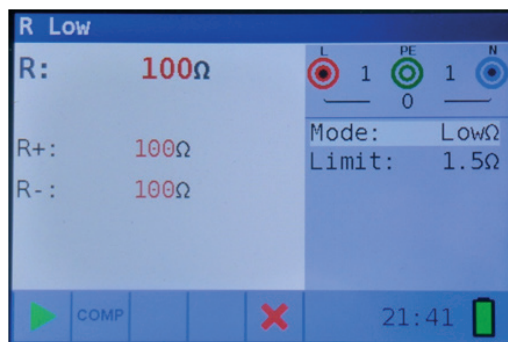
Figura 4 7: Ejemplo de resultados de medición R Baja
